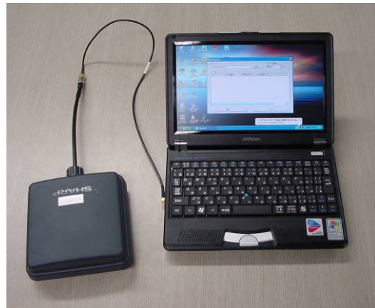
図 1 2005 年度の統合端末 (パッシブ RFID 用アンテナと PC)
