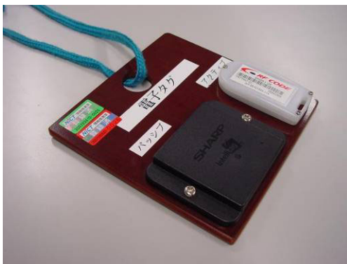
図4 ハイブリッドRFID (黒がパッシブ、白がアクティブ)
