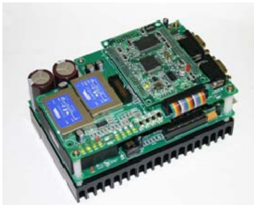
図3 コントローラ、ドライブ基盤
