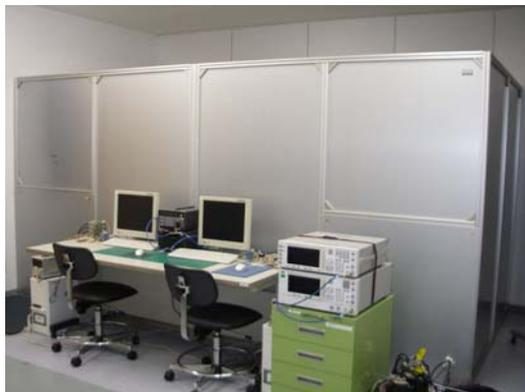
図3 試作した電波反射箱 (4mx2mx2m)
