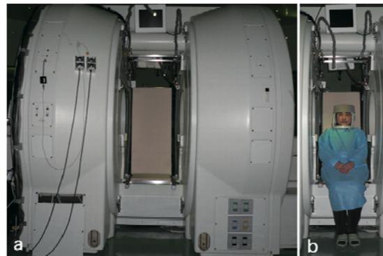
Fig.2 (a): 0.5-Tesla SIGNA-SP/i™ open-configuration MRI system (General Electric Medical Systems, Milwaukee, WI) ドーナツ型のマグネットが2つ並ぶ構造になっている。中央に特注の椅子を設置している。(b): 被験者は椅子に座り、頭に受信用のコイル(SIGNA-SP FLEX 4 coil)を巻いて撮影を行った。
