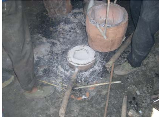
写真7 俄亜での溶解炉の設置
