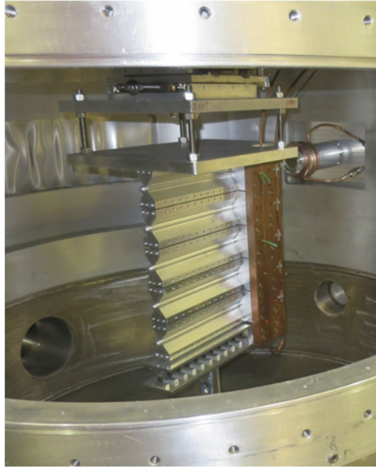
図1. ジェファーソン研究所において実験に使用した低温ガス標的。25cm 長の葉巻型のガス標的を5本用意して上から三重水素、水素、重水素、ヘリウム3 ガスを封入した。最後の5本目はバックグラウンドを調べるための空容器である
