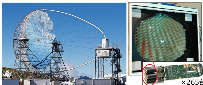
図 2 スペイン・ラパルマ島に設置された CTA 大口径望遠鏡初号基(主鏡は分割鏡約 200 枚で構成)と焦点面カメラ(光電子増倍管約 2 千本と読み出し回路)。
