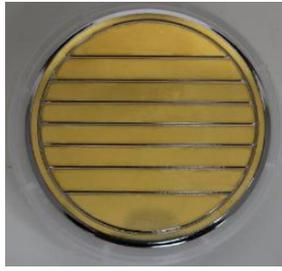
図3. 開発した Si(Li)検出器(センサ部分)。直径 10cm, 厚さ 2.5mm, セグメント数 8, エネルギー分解能 4keV(使用温度<-35 )。
