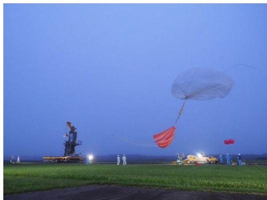
図 4 スプーラー開放直後の体積 2,000 m<sup>3</sup> の気球の写真。気球は大きく変形しており、その際に、穴が発生したものと推測される。
