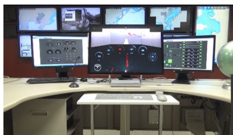
図 3 先端ナビゲートシステムと遠隔操船装置(PC 版)
