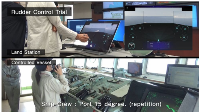
図10 先端ナビゲートシステムと遠隔操船装置による遠隔操船実験 2019年7月18日
