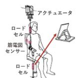
実際の動作アシストによる筋力減少（筋力）は人間の意図的な筋力減少に比べてどのような特徴を持つのでしょうか。この実験ではアクチュエータ（一定の力でアシストを与えるように設計）を用いて、肘関節運動時に様々な速度・カレレベルを持つアシストを13名の被験者に提供しました<sup>4)</sup>。
