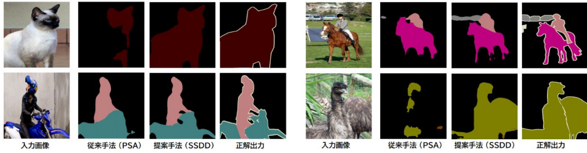
図 3 ICCV2019 で発表した手法 SSDD による領域分割結果．従来手法の精度は 59.0%であるのに対して、提案手法は 64.9%を達成した。
