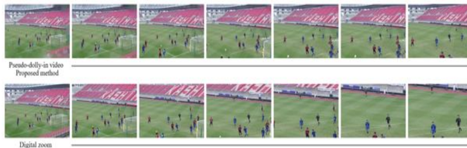
図 1：上段は提案手法による疑似ドリー映像（運動視差が再現）。 下段はデジタルズーム画像（運動視差の再現不能）
