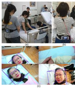
図 2 (a) データ計測の様子, (b) 頭部装着カメラと映像録画, (c) 頭部装着カメラによる映像（一人称視点映像）と顔検出結果
