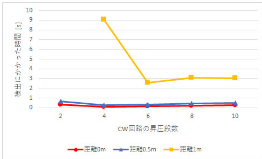
図7：回路の昇圧段数とノイズ源との距離による人検出時間
