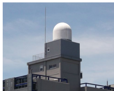
図2 大阪大学設置のXバンドフェーズドアレイ気象レーダ
