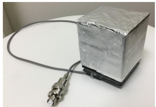
図5. 製作した超小型ミュオン検出器。植毛紙は外した状態
