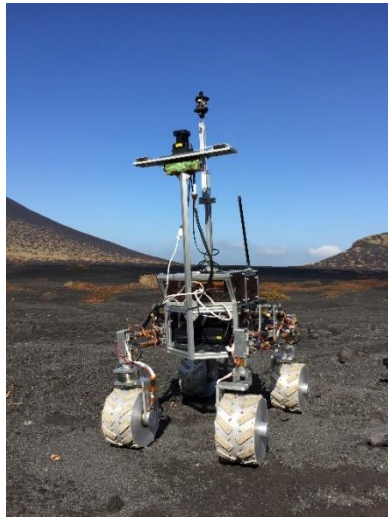
図 10. 移動ロボットによる実フィールドでの移動実験の様子。走行範囲の判別しつつ大局的な地図を作成することで、開発した超小型ミュオグラフィ計測器による観測において決定的に重要であることがわかった、プロトンによるノイズを遮蔽する有効な地形的特徴を探し出すことが可能となった。
