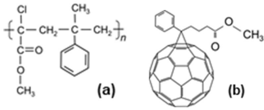
図5 (a) 用いた有機電子線レジスト ZEP520a 及び (b) 混合したフラーレン PCBM。
