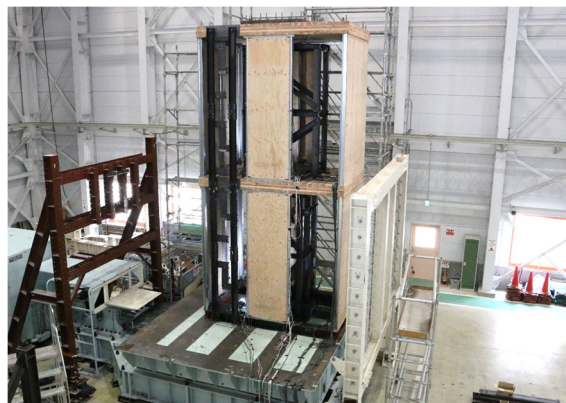
写真 1 実寸 2 層試験体の振動台加振実験
