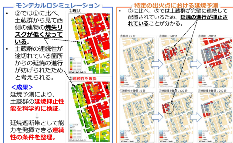
図 5：延焼シミュレーションを用いた伝統的な土蔵群による延焼抑止効果の検証
