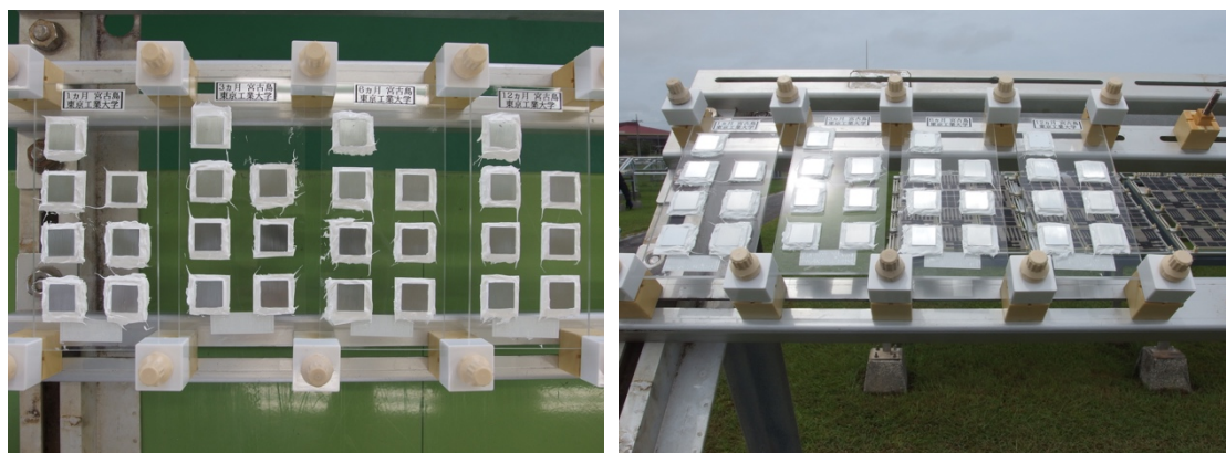
図2 各種Zn合金材の大気暴露試験の様子(宮古島試験場)。
