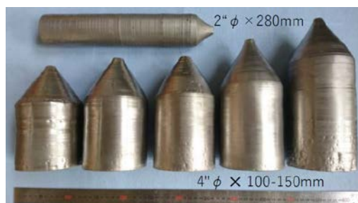
図 1 Czochralski 法により育成した [100] 方位の大型 Fe-Ga 合金単結晶インゴット(直径 2 インチおよび 4 インチ)の外観(福田結晶技術研究所との共同開発)。
