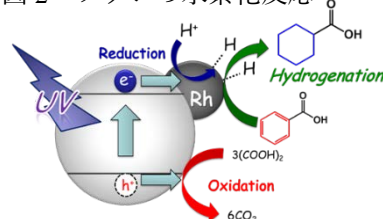
図3 安息香酸の核水素化反応
