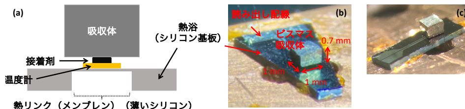
図1 単ピクセルTES型マイクロカロリメータの(a)概念図と(b)(c)写真
