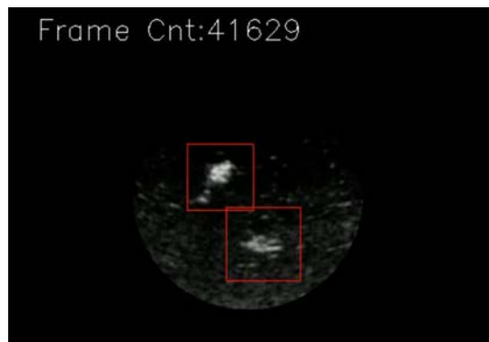
図 3 カスケード分類器を用いた魚の自動検出と検出されたフレーム枚数の計数
