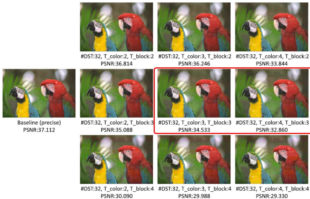
図 6 : 従来手法 (Baseline) に対する提案手法の有効性評価 (複数指標を総合的に評価し、赤枠内 2 つのパラメータ設定において特に高効率)
