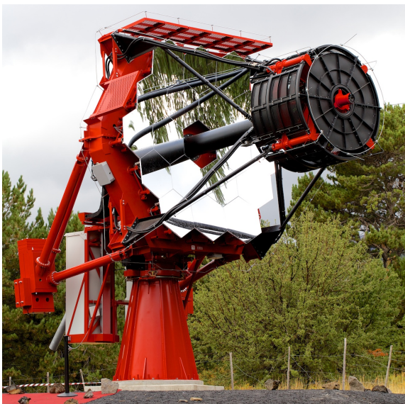
図 2：図 1 の焦点面カメラを搭載し試験観測を行った、CTA 小口径望遠鏡の試作機。イタリアのシチリア島に設置されている中心に見えるのが非球面分割鏡で構成される光学系主鏡（直径 4 m）、右上の黒い部分は、非球面の副鏡（直径 2 m）を保持する構造である。焦点面カメラはこの写真には写っていないが、主鏡と副鏡の間に設置された。
