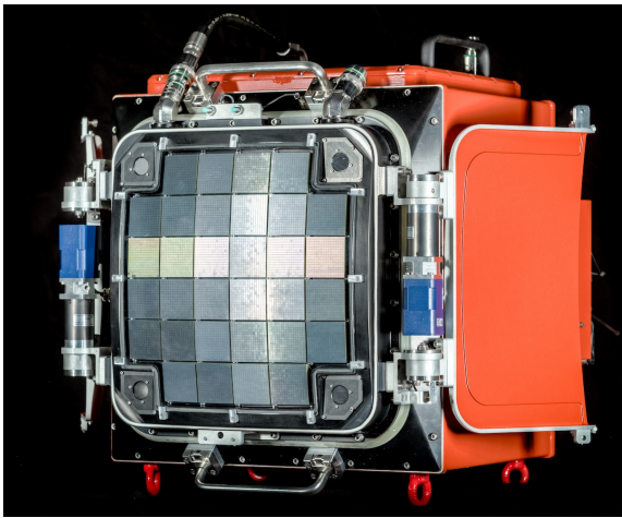
図 1：本研究で製作した CTA 小口径望遠鏡のカメラ試作 2 号機の写真。正方形に並んでいる部分が半導体光検出器で、一つずつの正方形が 64 読み出し画素に対応している。カメラ全体は、一辺がおよそ 45 cm の立方体に近い形状であり、2048 画素を持つチェレンコフ望遠鏡用のカメラとしては小型に収まっている。光検出器の背後には、同じく本研究で製作した読み出し回路が収まっているが、写真には写っていない。（写真提供：Christian Föhr、マックスプランク核物理学研究所）
