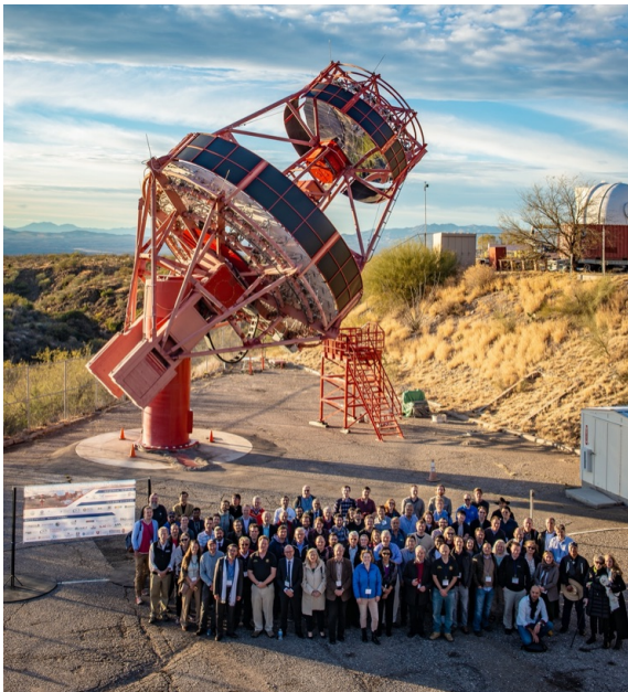
図 4 : CTA 中口径望遠鏡の試作機。図 2 の望遠鏡と同様、非球面の主鏡と副鏡が使用されているが、こちらのほうが主鏡直径が 10 m と大きい。
