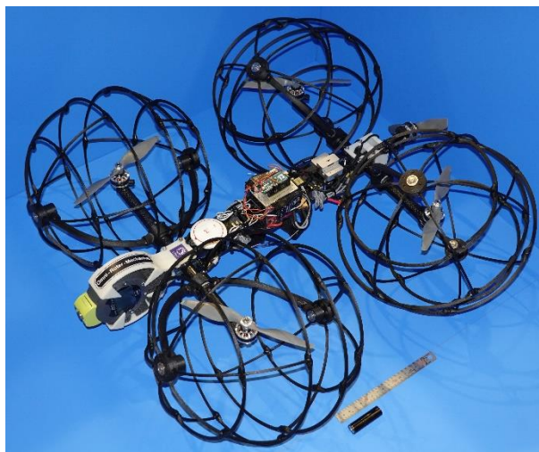
図2：分割球殻ロータ機構（分散型複数配置方式）
