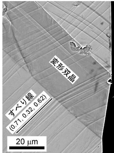
図2 <101>すべりが観察された試料の電子顕微鏡写真。
