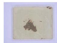
図6. ネガ型レジストを用いたTlBrへの電極形成の結果
