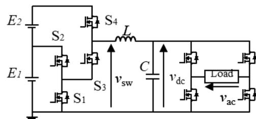
図 1 HEECS インバータの回路図
