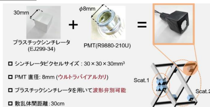
図1: 本研究で開発した中性子カメラ(原理検証機:8ユニット)の構成。n/ \gamma 弁別型プラスチックシンチレータと小型PMTを一体化し、30cm程度離れた前段・後段で配置した
