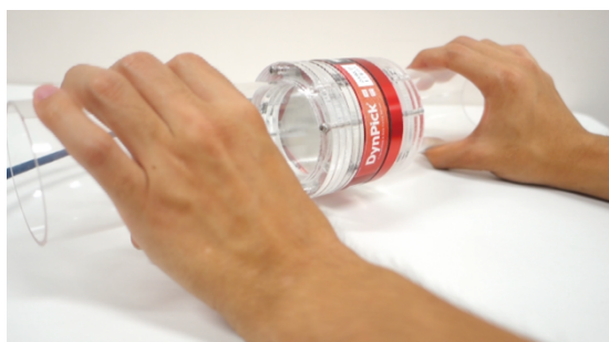
図8 物体へ両手で力をかけた際の方向・大きさ計測デバイス
