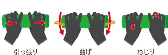
図6 学習する8種類の力方向（逆方向は省略） 図7 推定結果（左：把持力推定誤差，右：力方向識別精度）
