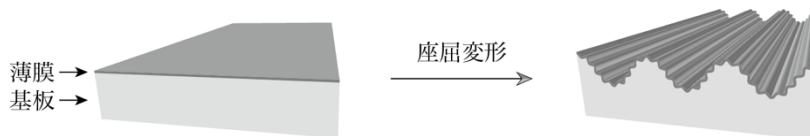
図1. 薄膜-基板系階層リンクルの模式図
