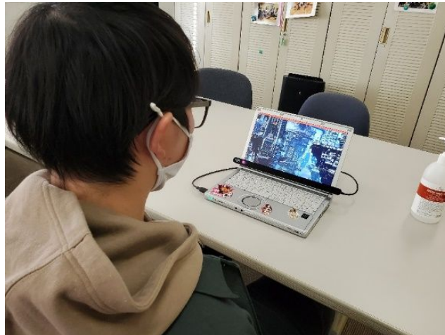
図5．画像注視認証（ノートPCに視線入力装置を設置）
