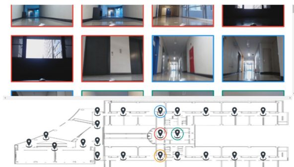
図1：自律移動ロボットによる被災状況の自動収集
