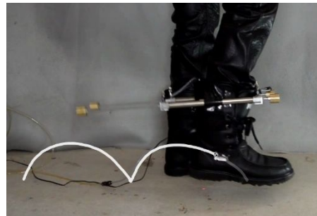
図4 人間の脛に付けたアシスト装置
