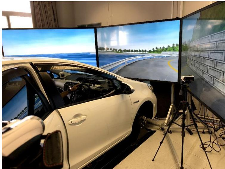
図 1 実車を用いたドライビングシミュレータの外観
