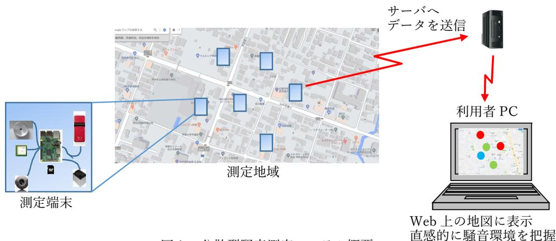
図1 分散型騒音測定システム概要
