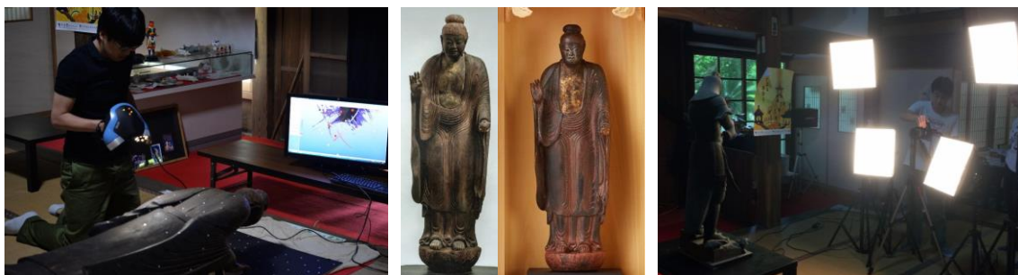
図2. 歴史的造形資源の造形データの取得ならびに取得したデータ活用（左から、ハンディスキャナを活用した取得の様子（対象：小松寺本尊「薬師如来立像」）、本尊（高さ1430mm）と出力モデル（分身として提供、高さ180mm）、フォトグラメトリー法による取得の様子）
