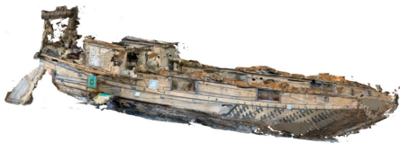
図 13 写真測量で得られた丸子船のメッシュデータ
