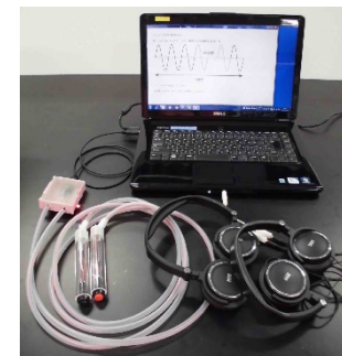
図2 音の高低と周波数の関係を学ぶ機器
