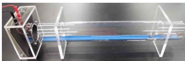
図3 気柱の共鳴の音圧分布を示す装置
