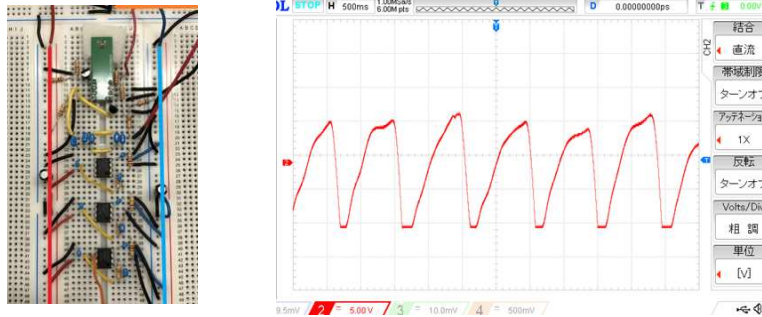
図5 学生が作成した脈拍計回路例 と A 学生が測定した A 学生の脈拍波形の例
