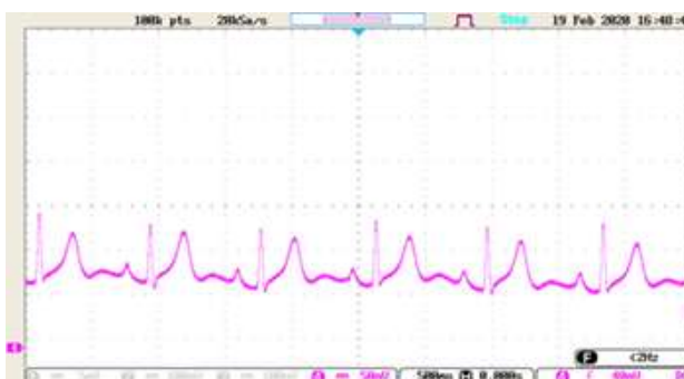
図3 A学生が測定したA学生の心電図波形の例
