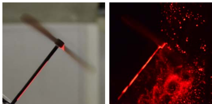
Fig.1 竹とんぼの翼端渦の可視化
