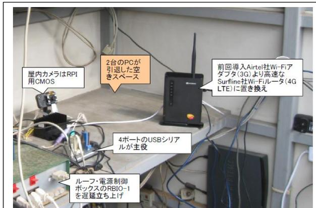
図 1：デスクトップ PC を RP3 に置き換え、インターネット接続は Wi-Fi 化した天文台制御系。
