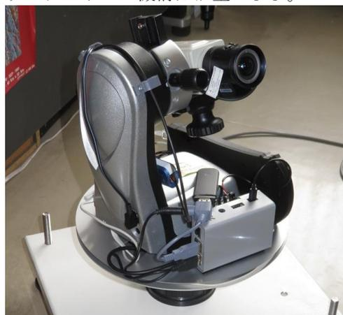
図4：新しいチルトパン機構。電動経緯台 SynScan を採用している。
