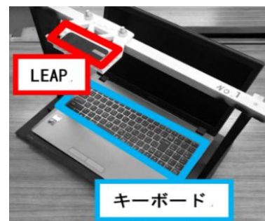
図11 指を認識したタイピング練習システム
