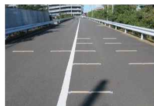
図 3: 振動発生源の設置
