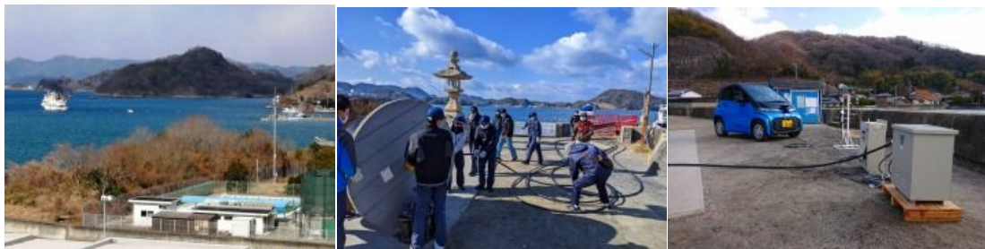
Fig.3 実験海域 (左)・ケーブルの展開 (中)・陸上受電装置と電気自動車への給電 (右)
