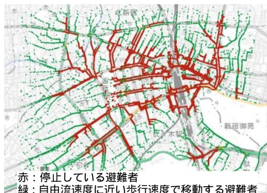
図2 建物の構造的被害等により在館者の半数が屋外避難した場合の混乱状況(避難開始から45分後のシミュレーション結果)
