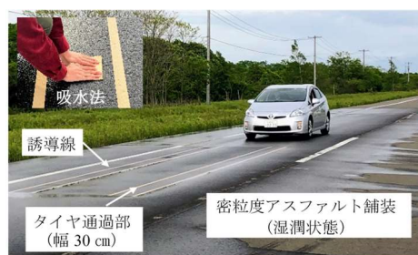
図3 車両飛散に関する走行試験の概要図
