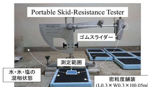
図2 塩溶液の凍結過程におけるすべり特性に関する室内実験
